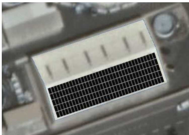
Figura 1.- Distribución de módulos fotovoltaicos
