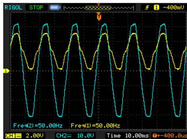
Figura IV.9. Señal de red y señal acondicionada.
