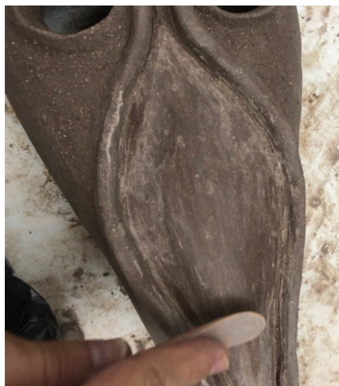
Ilustración 37 pulido de la pieza.
