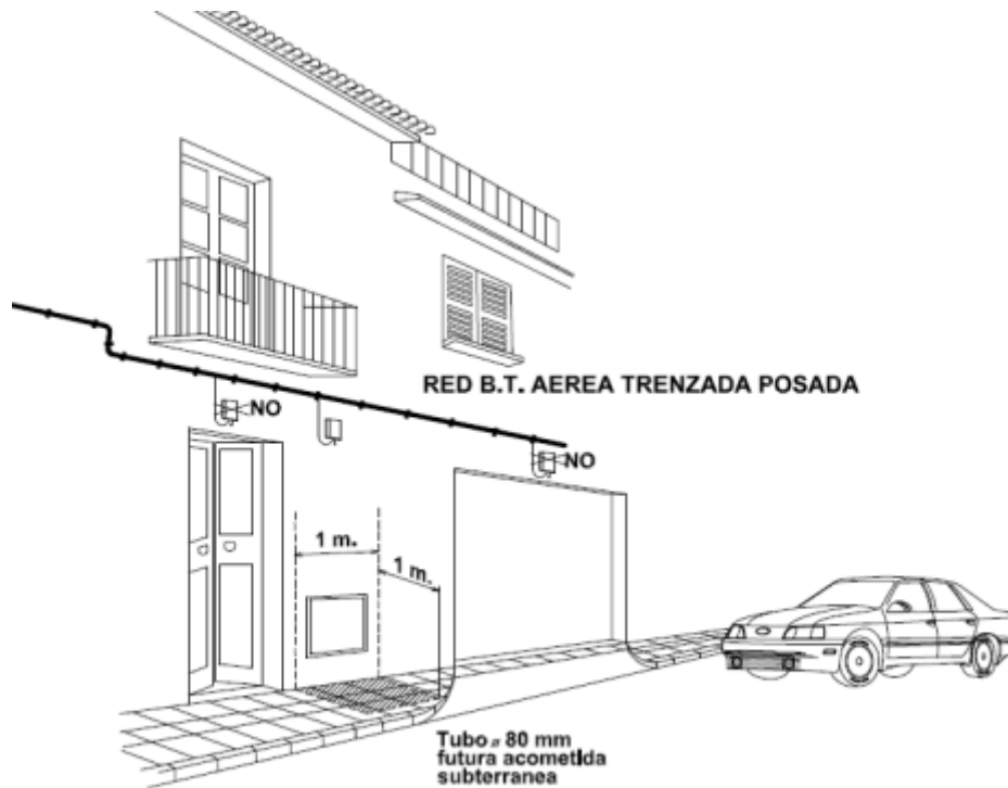
Figura 2. Emplazamiento de la Caja General de Protección
