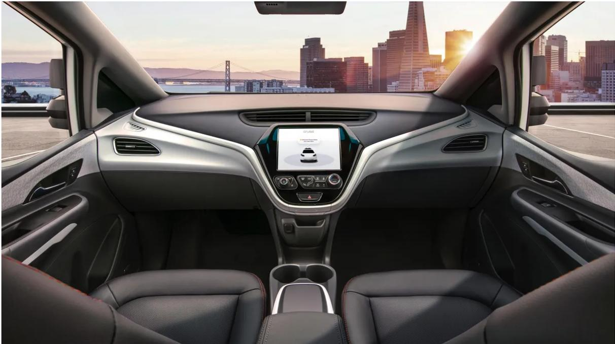
El interior del vehículo ha sido diseñado sin la inclusión de elementos que permitan la conducción llevada a cabo por el usuario tales como el volante o pedales.
