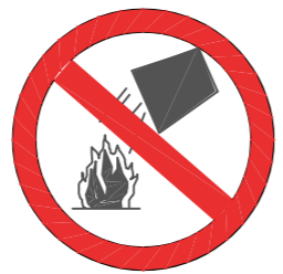
PROHIBIDO APAGAR CON AGUA
