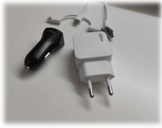
Figura 22. Fuente de alimentación, 5V y 2,4 A
