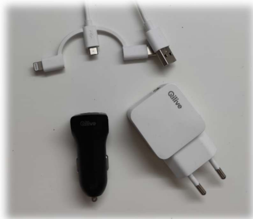
Figura 22. Fuente de alimentación, 5V y 2,4 A
