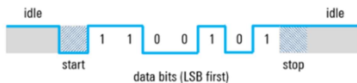
Figura 5. Representación de bits de una señal de comunicación UART, obtenida de fuente [14]
