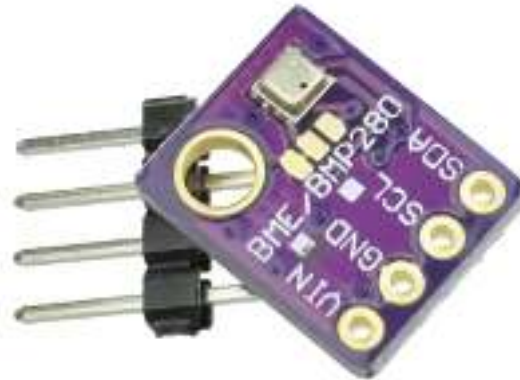
Figura 3.6: Sensor BME-280 antes de soldar sus conectores.
