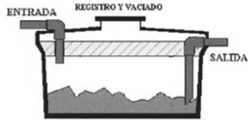
Gráfico – 15. Esquema del Depósito de aceites.
