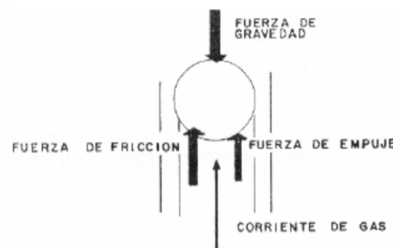
Gráfico – 9. Fuerzas que influyen en una partícula en suspensión en el aire.
