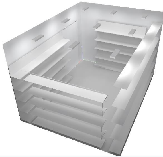
Ilustración 7: Disposición luminarias cámara frigorífica 1
