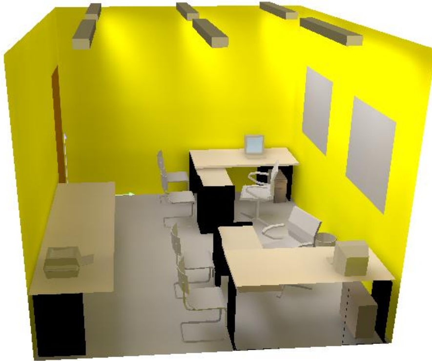
Ilustración 4: Disposición luminarias oficina
