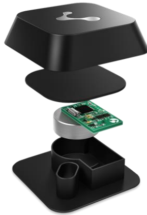
Figura 2.5. Despiece Smart beacon de Kontakt (Kontakt.io)
