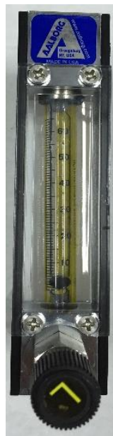
Figura 5.5: rotámetro de agua de la marca AALBORG modelo PMR1-016361
