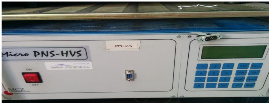
Figura 1.2 Dispositivo principal del Captador secuencial de aerosoles.
