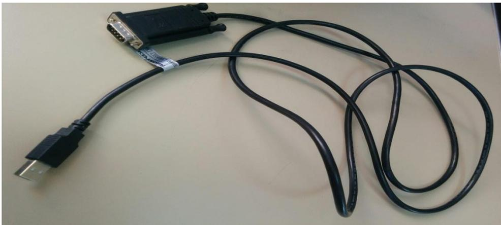
Figura 2.1 Cable DB-9 RS232 – USB que utilizamos para conectarnos.
