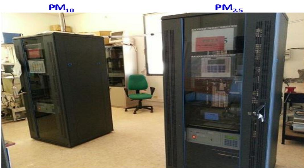
Figura 1.1 Captadores secuenciales de aerosoles con los que nos vamos a comunicar.
