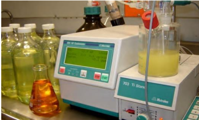
Ilustración 35: Análisis de aceite dieléctrico (Rymel, 2016)
