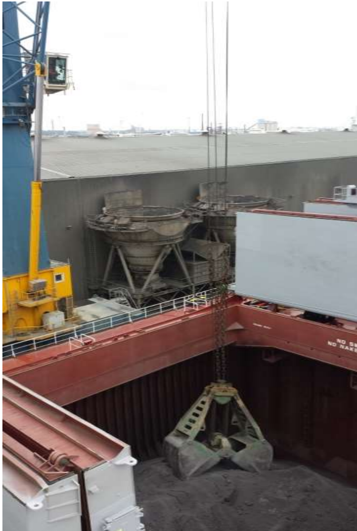
Ilustración 32 Descarga con cuchara a tolva. Fuente: Elaboración propia
