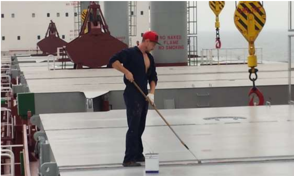
Ilustración 19 Pintando la cubierta. Fuente: Trabajo de campo.
