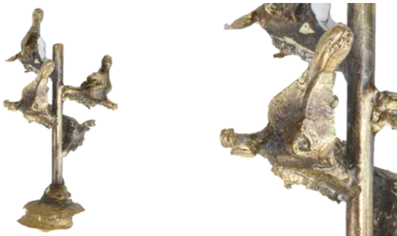
Fig. 6. Comparativa de registro superficial del modelo de cera y su reproducción en latón de una «cabeza» perteneciente al árbol de jirafas.
