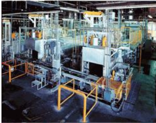
Ilustración n° 18. Horno de paso continuo con transporte de ruedas cerámicas
