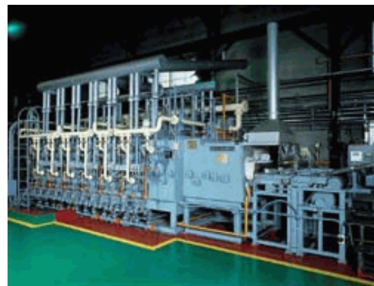
Ilustración n° 19. Horno de cadenas continuo para carburación de acero
