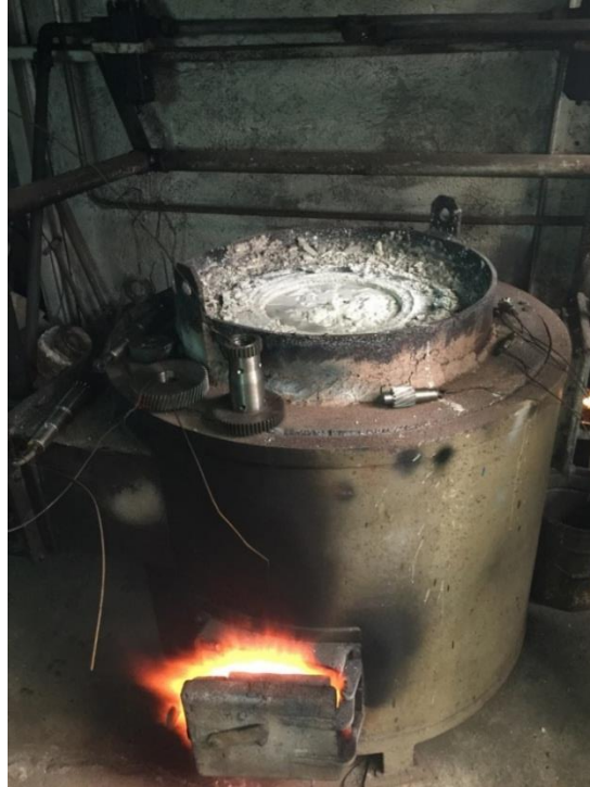
Ilustración n° 40. Pre calentamiento sales
