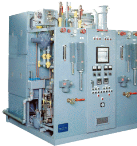
Ilustración n° 17. Generador para la producción de gas endotérmico
