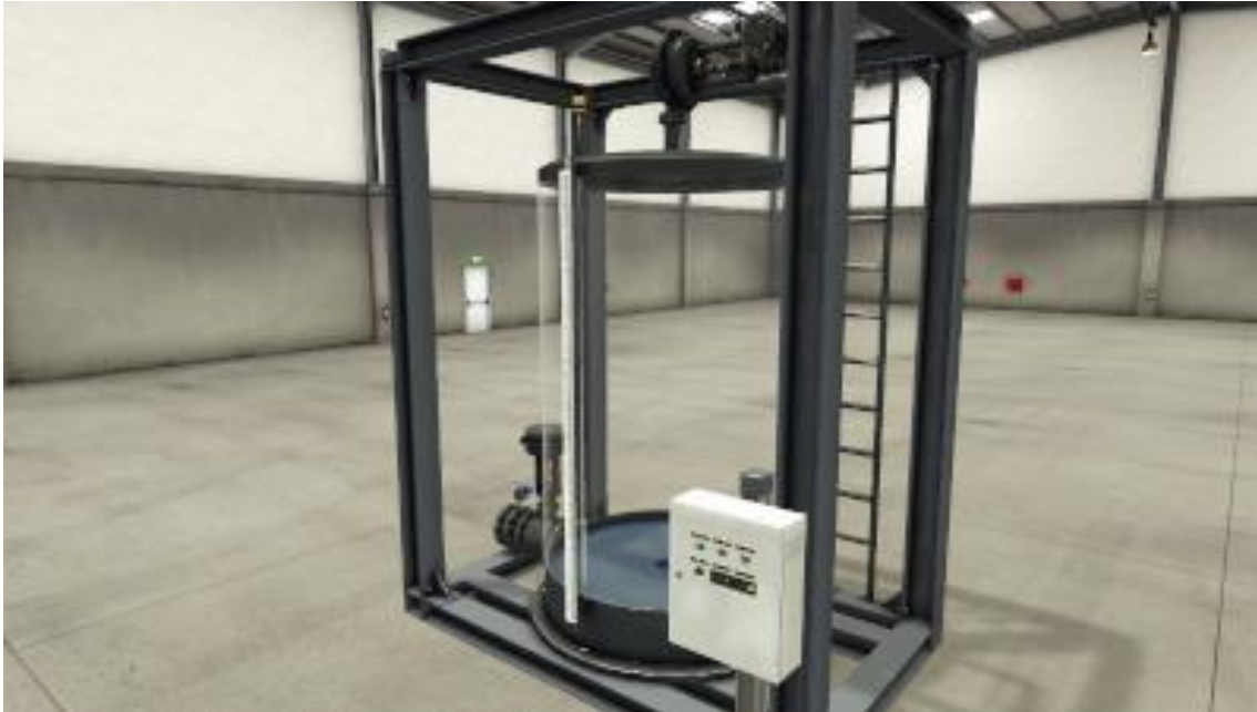
Figura 42.- Control de nivel [1].
