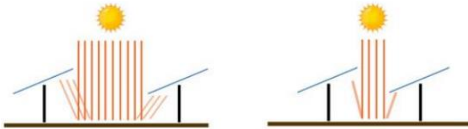
Figura 43. Influencia de la distancia de los paneles o pitch en la irradiancia solar sobre la cara trasera de un módulo fotovoltaico bifacial [21].
