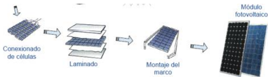
Figura 30. Proceso de fabricación de un módulo fotovoltaico [4].
