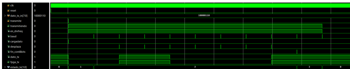
Figura 32. Simulación de la transmisión mediante UART del dato “10000110”
