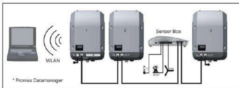
Figura 2. Esquema de conexión Sensor Box. Fuente: Fronius
