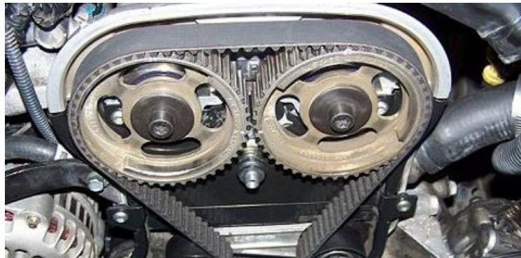
Figura 4. Transmisión por correa dentada en la distribución de un vehículo. Fuente: http://automocionmiraflores.com/cuando-cambiar-la-correa-de-distribucion/
