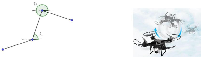
Figura 2.2: Un brazo robótico que se mueve en el plano. Un dron tiene una posición rotacional por cada posición espacial.
