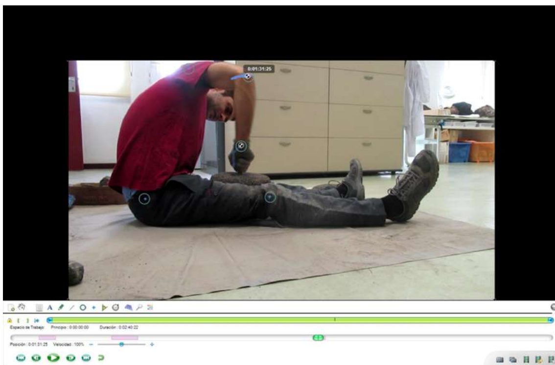
Figura 82. Instantánea de ejemplo de la herramienta “ track path ” en los marcadores del codo y la muñeca durante el proceso de perforación del agujero central del molino.
