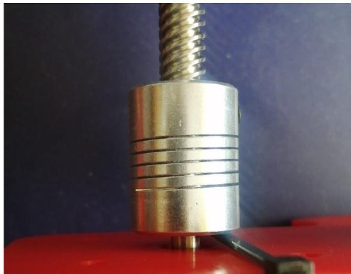
Figura 43. Unión tornillo sin fin con los motores.
