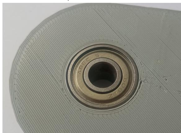
Figura 39. Rodamientos encajados en los soportes.
