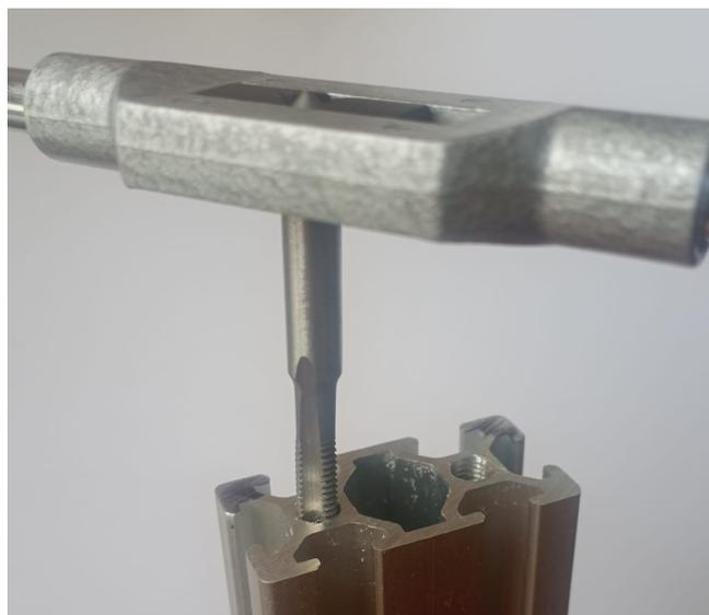
Figura 41. Creación de rosca en los perfiles.
