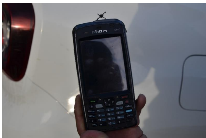
Figura 5. Dispositivo lector de los hidrantes
