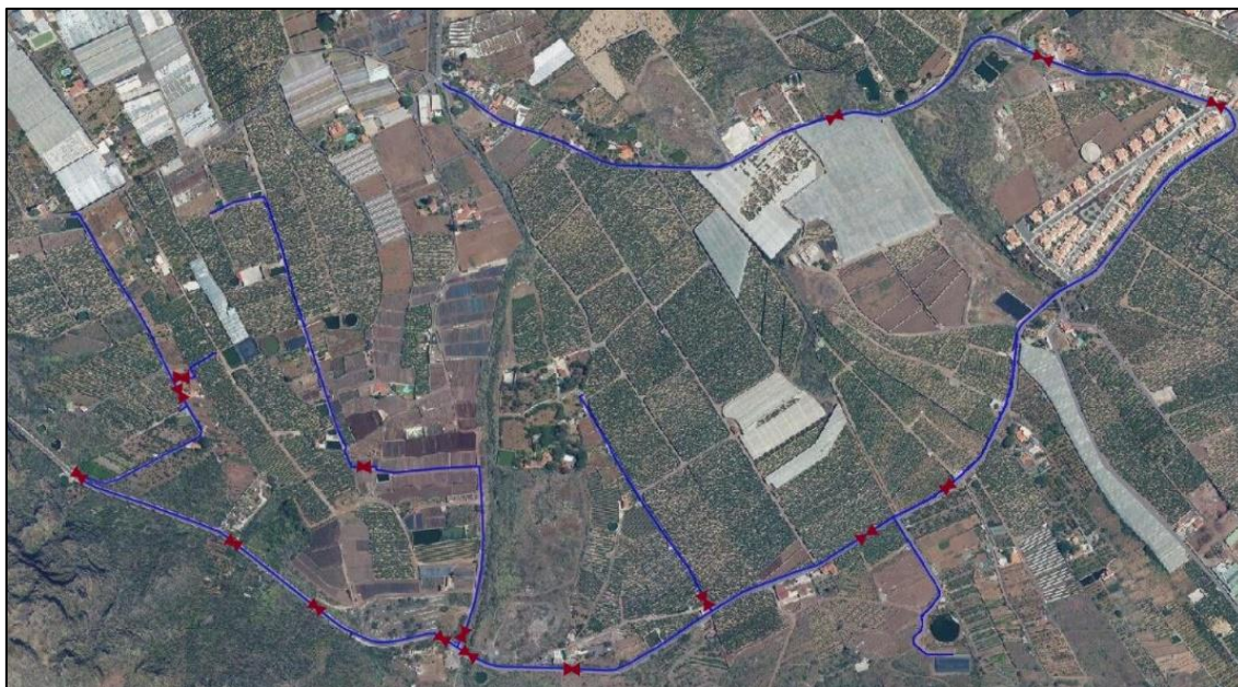
Figura 21. Distribución de las válvulas de corte
