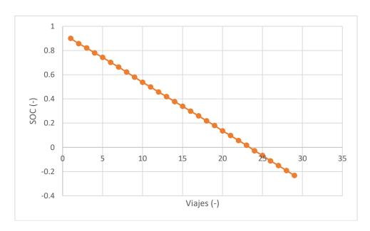
Figura 4.6. Evolución del SOC (Carga en cochera, Línea 020).
