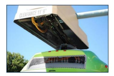
Figura 2.5. Cargador tipo pantógrafo, Foothill Transit, California.
