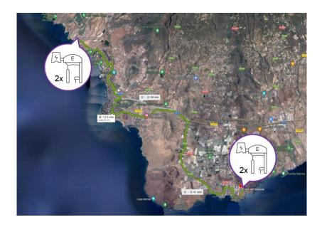
Figura 4.7. Ubicación de pantógrafos (Carga EOL, Línea 467).
