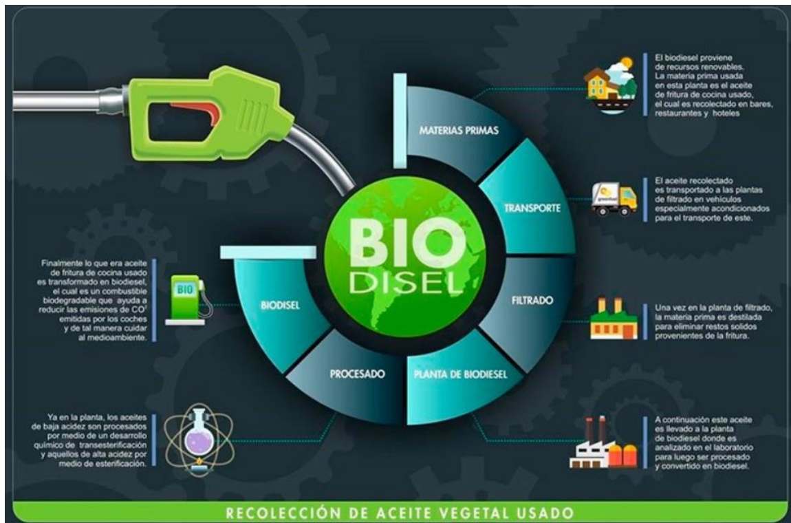
Figura 5. Proceso de generación del biodiésel (Fuente: Atlantic Biofuels).
