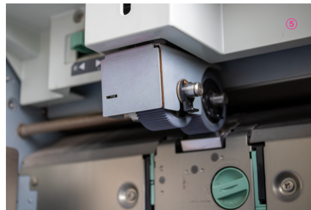
Fig. 41. Fotografía detalle del rodillo que impulsa el papel hacia el interior de la máquina.
