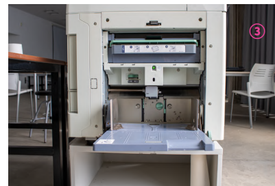
Fig. 39. Parte lateral izquierda de la máquina de risografía, donde vemos la bandeja de entrada del papel.
