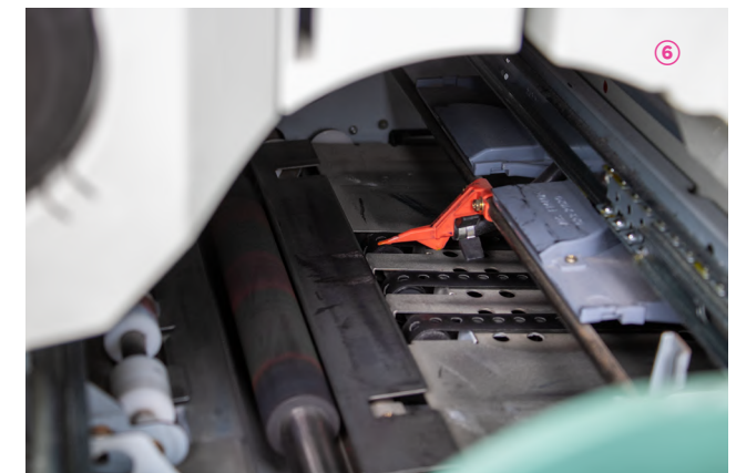
Fig. 42. Aguja encargada de separar el papel del tambor una vez realizada la impresión.
