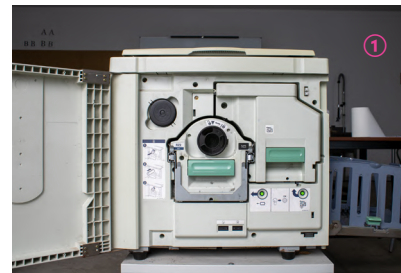
Fig. 37. Fotografía de la parte frontal de la máquina. Se puede ver el tambor y la unidad de creación de másteres.
