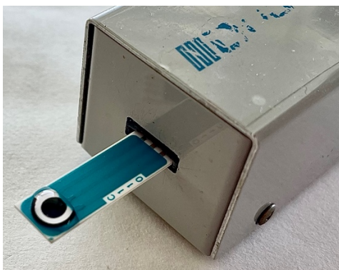
Figura 7. Producto enzimático sobre electrodo serigrafiado
