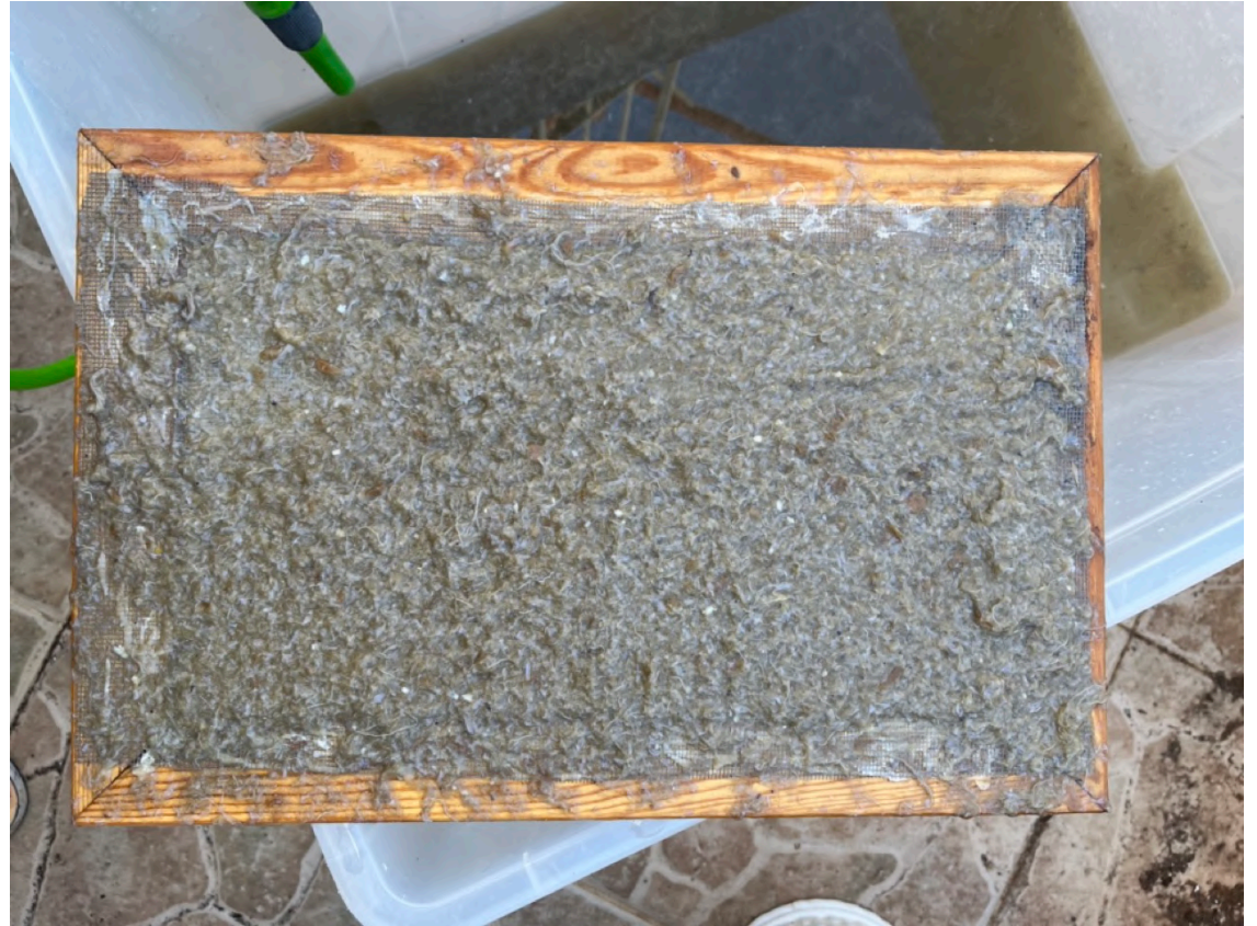
Fig. 68 Malla con componentes filtrando agua , 2023
