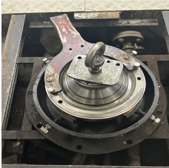
Ilustración 54. Llave de tetones colocada sobre el tambor.
