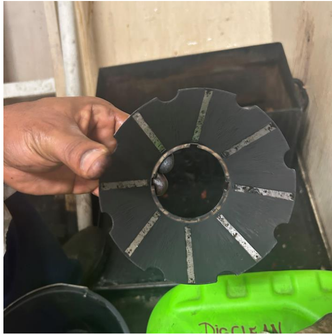
Ilustración 57. Disco con carbonilla.
