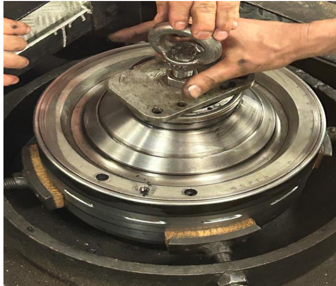
Ilustración 61. Placa colocada y apretada sobre la tapa del tambor.
