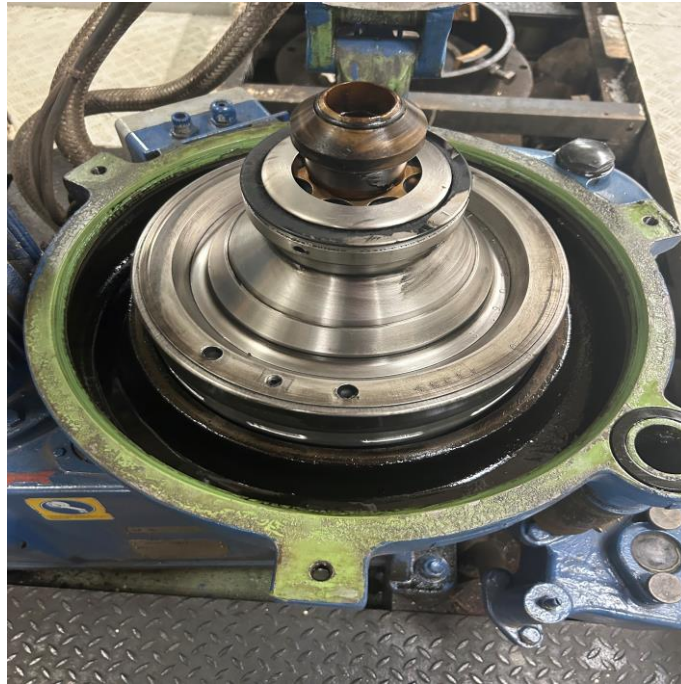
Ilustración 62. Tambor totalmente montado, con rodete y casquillo distanciador.
