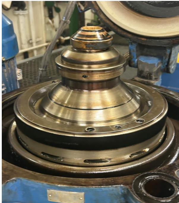
Ilustración 52. Tambor al descubierto tras desatornillar la tapa del chasis.
