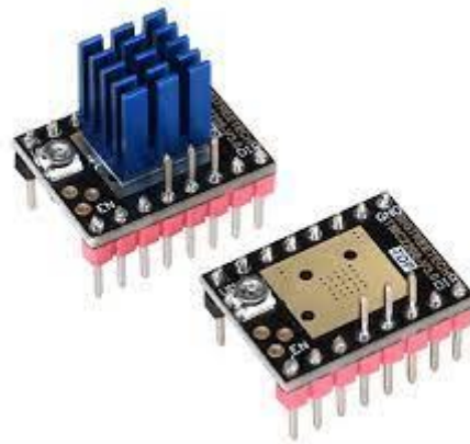
Figura 14: Driver TMC2208 V3.0 con disipador y sin disipador. Bibliografía de imágenes [16]
