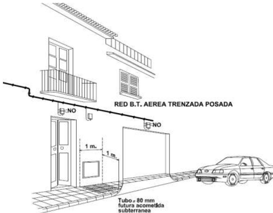
Figura 2. Emplazamiento de la Caja General de Protección
