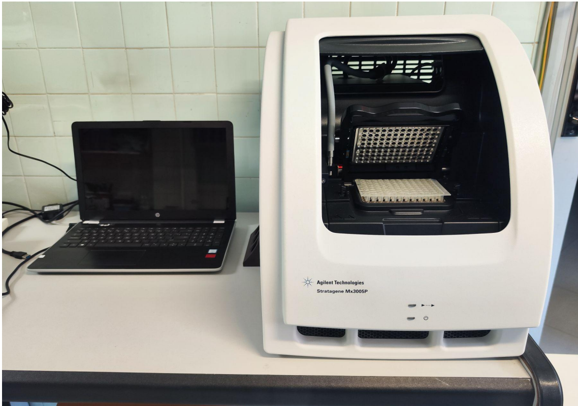
Dispositivo termociclador Stratagene MX3005P para qPCR con su sistema informático
