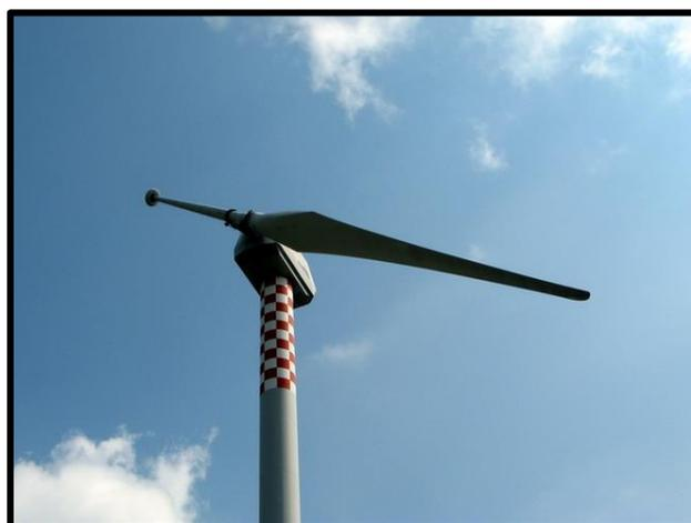
Figura 3.7. Aerogenerador de rotor monopala con contrapeso [7]
