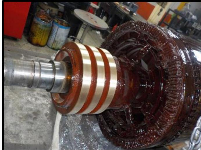
Figura 3.16. Anillos rozantes en un rotor bobinado de un generador asíncrono [16]
