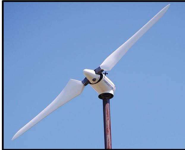
Figura 3.6. Aerogenerador de rotor basculante bipala [6]
