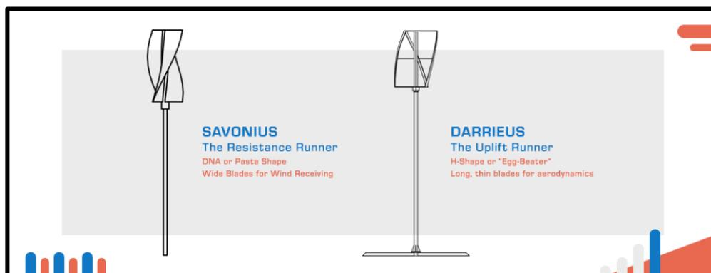
Figura 3.4. Clasificación de aerogeneradores de eje vertical [4]
