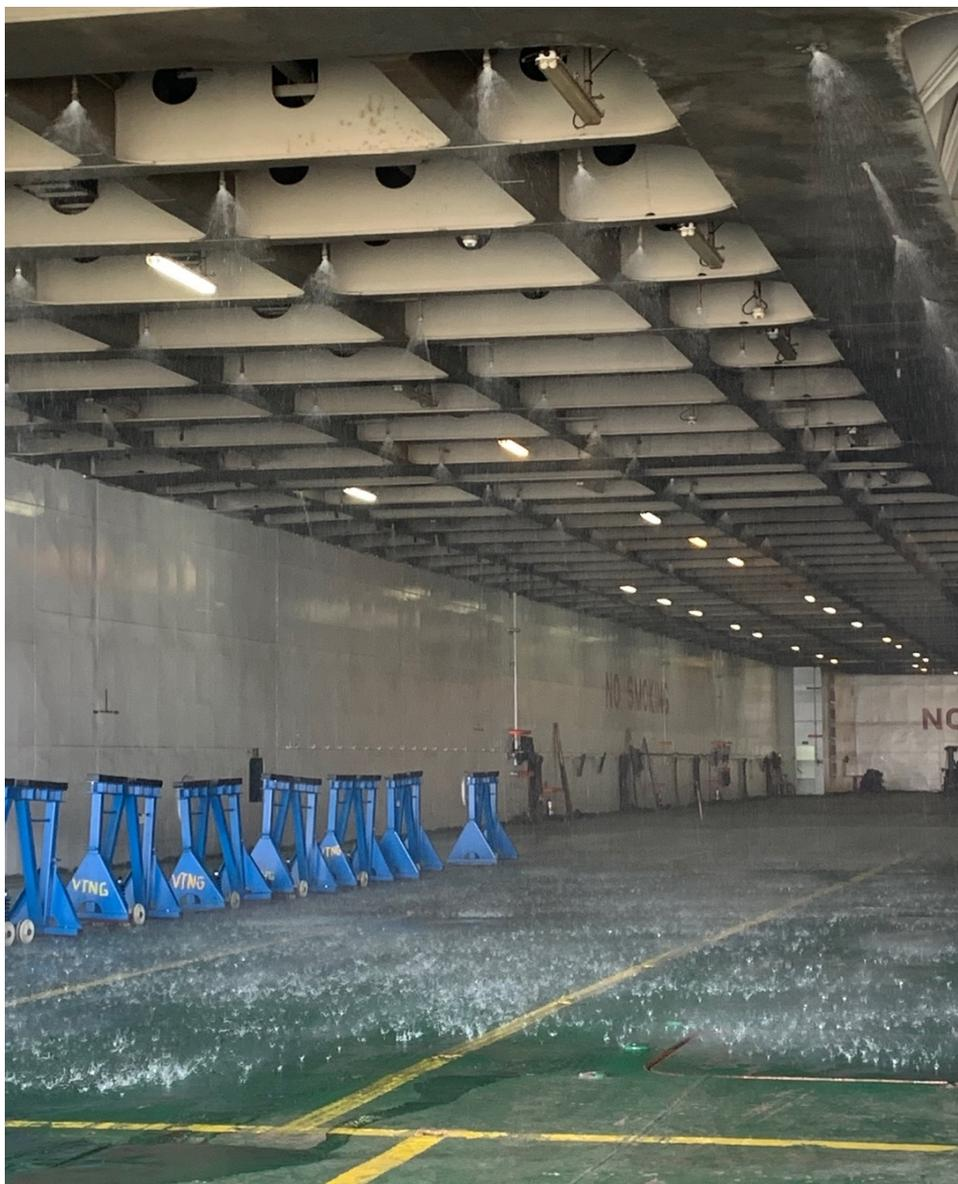
**Ilustración 33. Rociadores en inspección. Fuente: Elaboración propia.**
