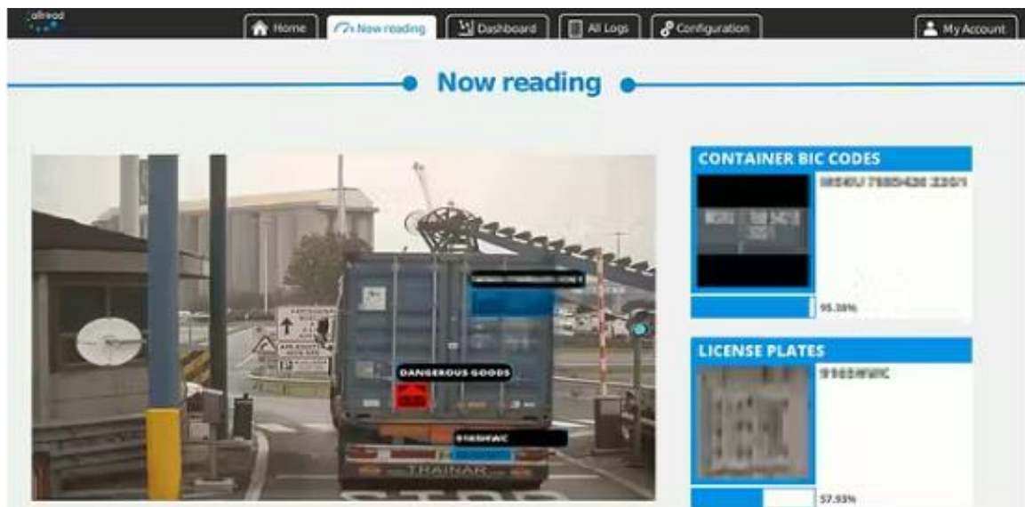
Ilustración 29. Pantalla del sistema OCR identificando un contenedor.
