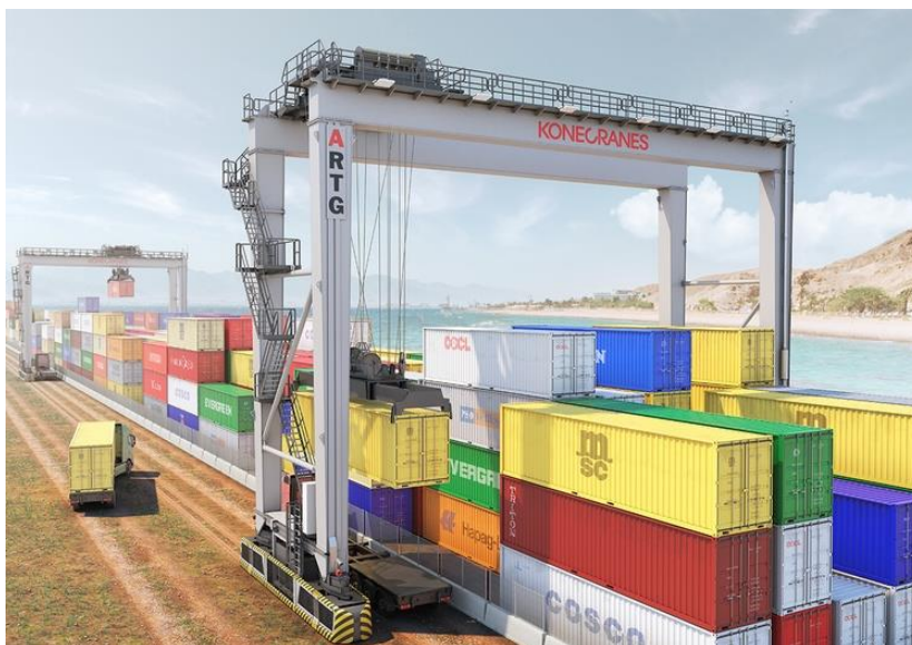
Ilustración 23. Grúa sobre ruedas automatizada (ARTG).
