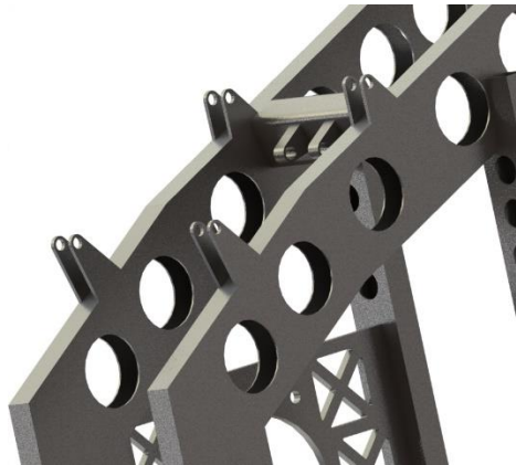
Imagen 47: Pletinas donde va sujeto el subchasis
