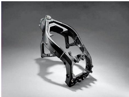
Imagen 9: Chasis doble viga perimetral. Fuente: publimotos.com
