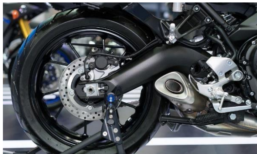
Imagen 16: Basculante de doble brazo. Fuente: motociclismo.es
