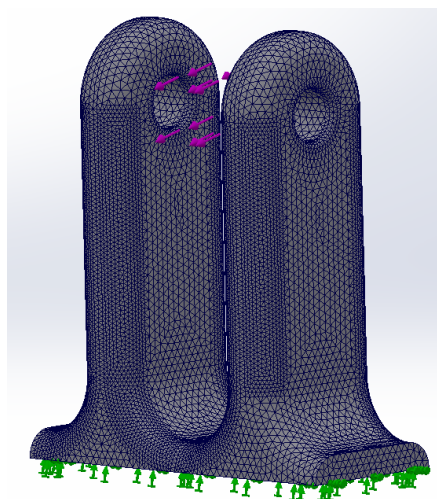
Imagen 69: Mallado utilizado para la simulación de las orejetas
