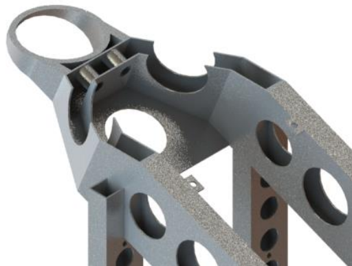
Imagen 44: Recorte de la estructura para observar la unión de la pipa con el chasis
