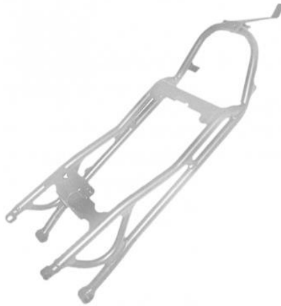
Imagen 15: Subchasis en aluminio modelo para Kawasaki Zx10R 08-10. Fuente: mscompeticion.com
