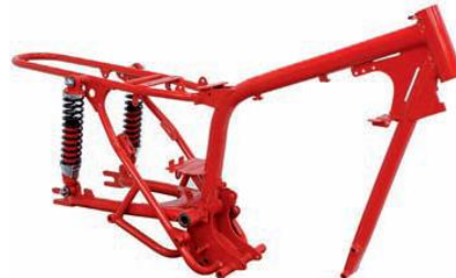
Imagen 6: Chasis simple cuna abierto o interrumpido Fuente publilmotos.com
