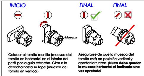
Colocar el tornillo martillo (muesca del tornillo en horizontal en el interior del perfil por la guía estrecha. Girar a la derecha hasta su tope (muesca del tornillo en vertical)
