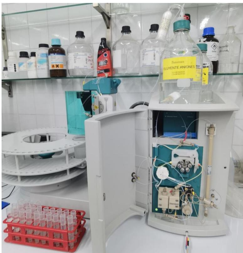
Imagen 6. Cromatógrafo iónico 883 Basic IC plus-Metrohm
