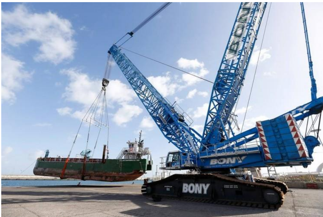
Ilustración 20. Grúa móvil elevando una gabarra. Fuente: https://www.puentedemando.com/la-nueva-grua-de-bony-en-el-puerto-tinerfeno-se-estrena-con-la-puesta-en-seco-de-una-gabarra/
