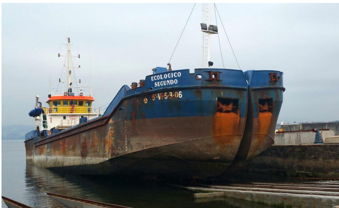
Ilustración 22. Buque subiendo a carro varadero en Ferrol. Fuente: https://pbs.twimg.com/media/CNQXX_DWoAA8ocB?format=jpg&name=large
