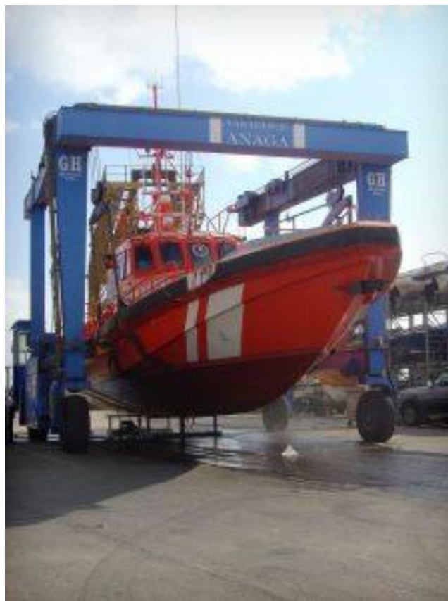
Ilustración 24. Travelift de Varaderos de Anaga. Fuente: https://spinnakercanarias.com/varaderos-anaga/
