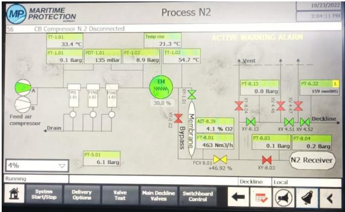
Figura 38. Process N2, vista de la HMI. Fuente: Trabajo de campo.
