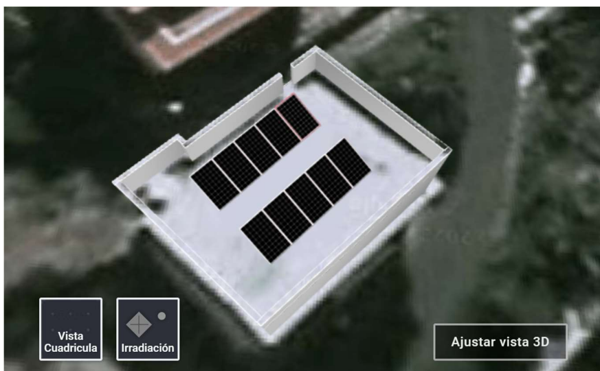
Figura 6: Imagen de Instalación Fotovoltaica Opción 2.
