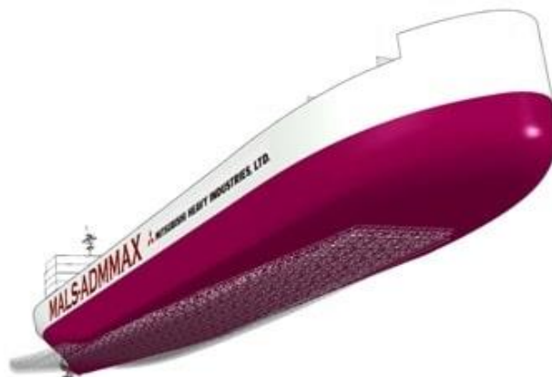
Ilustración 15. Air Lubrication System. Fuente: https://www.marineinsight.com .
