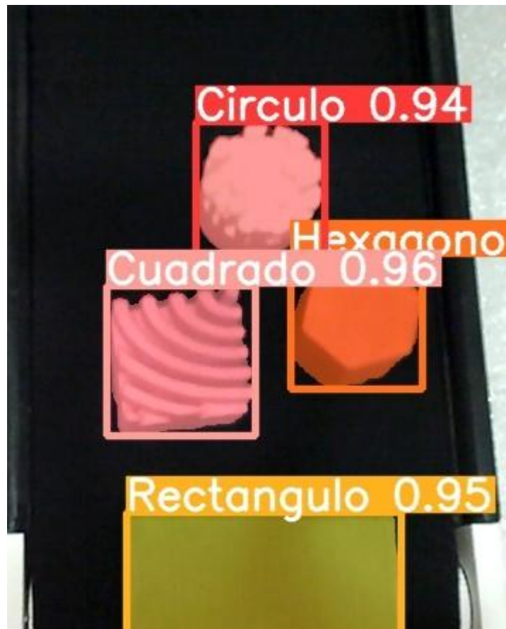
Figura 38: Detección y segmentación de objetos sobre la cinta transportadora
