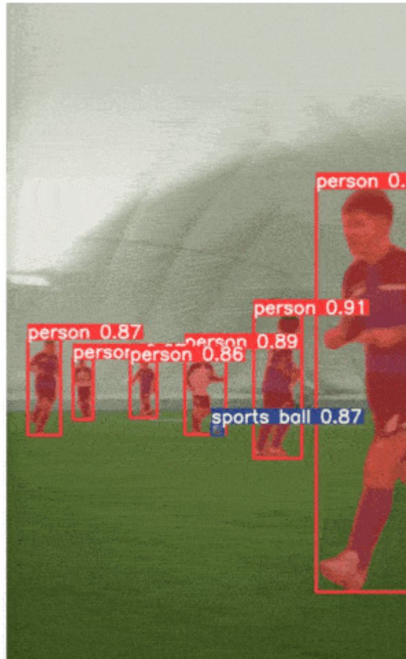
Figura 9: Ejemplo de aplicación de un modelo pre entrenado de YOLOv8 para la detección y segmentación de objetos
