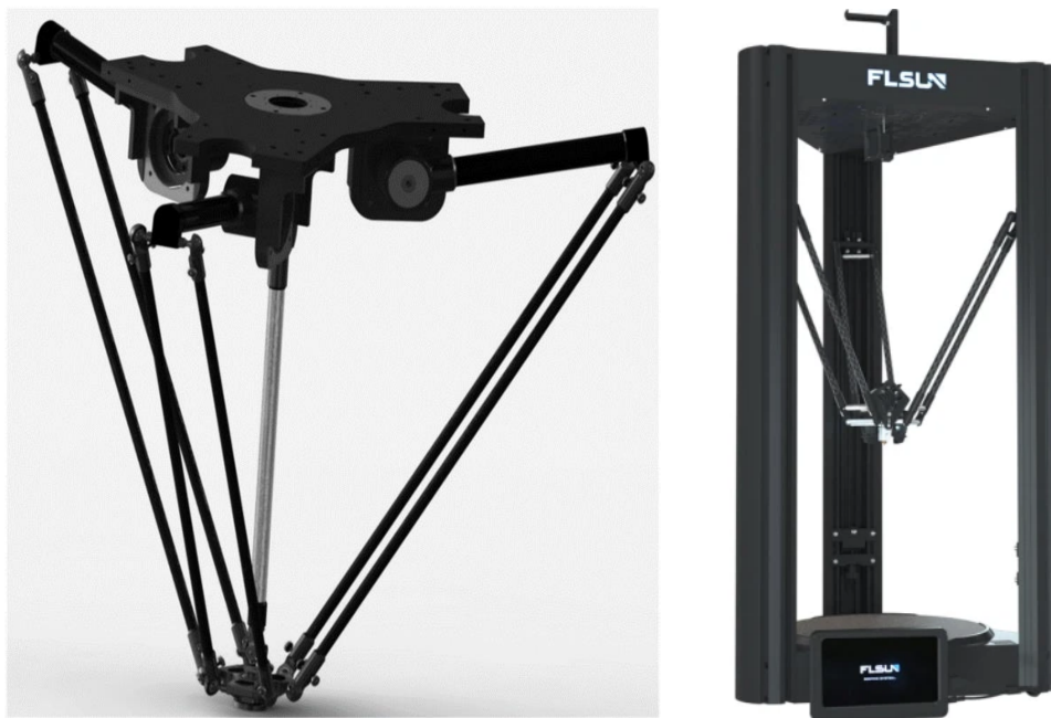
Figura 1: Ejemplos de Robots Delta
