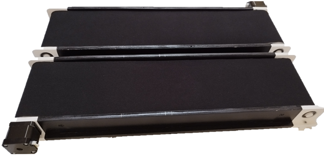
Figura 56: Cintas transportadoras impresas en 3D (vista superior)
