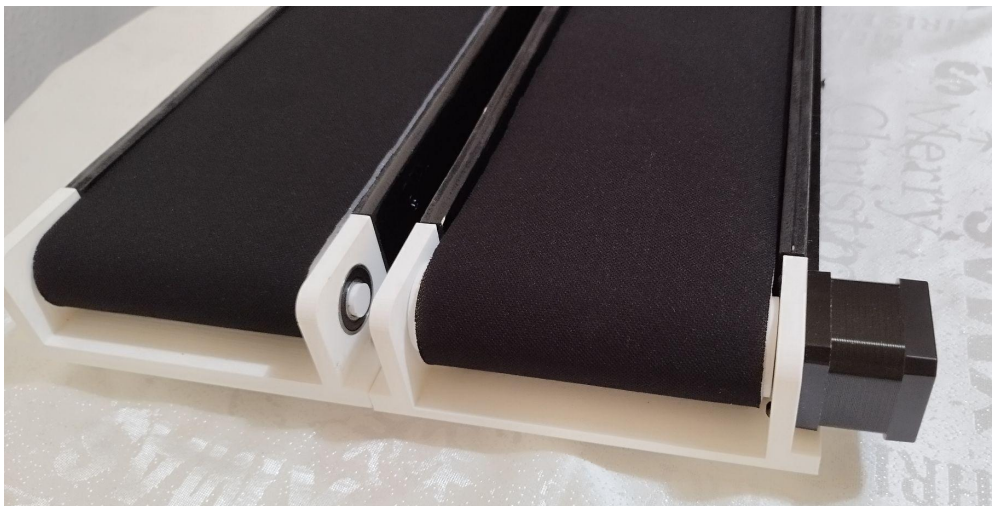
Figura 55: Cintas transportadoras impresas en 3D (vista lateral)
