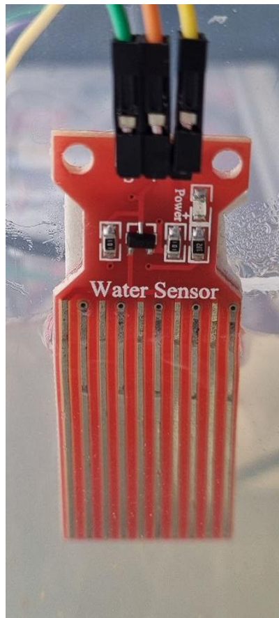
Ilustración 10 Módulo sensor nivel de agua
