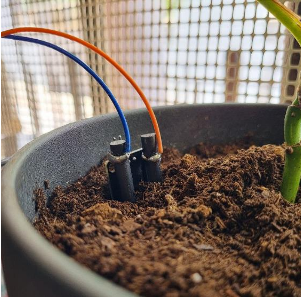
Ilustración 10 Varas de grafito para sensor de humedad del suelo
