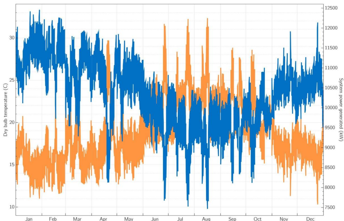
Figura 84: Impacto de la temperatura ambiente (naranja) sobre la generación de potencia (azul) durante un año para una planta binaria diseñada a la T ambiente promedio anual.
