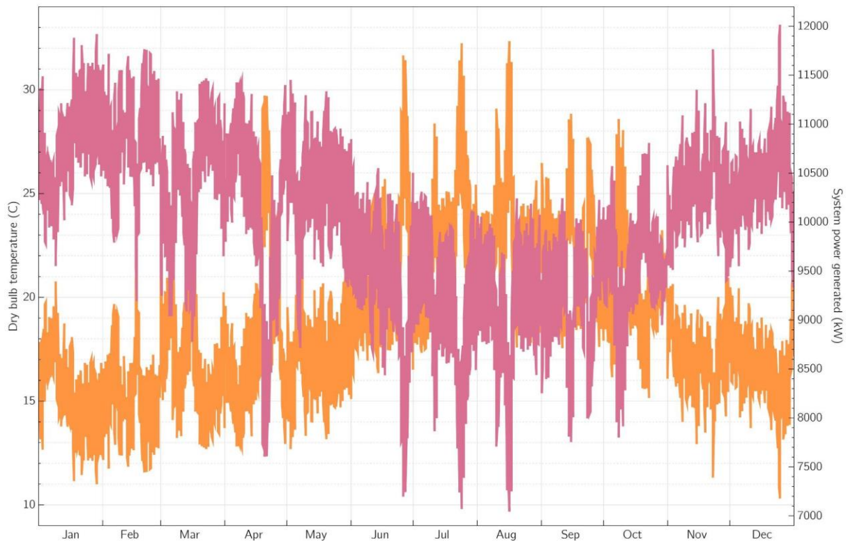
Figura 110 Impacto de la temperatura ambiente (naranja) sobre la generación de potencia (rosa) durante un año.
