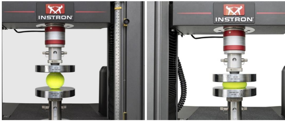
Figura 7.2. Ensayo a compresión de una pelota de tenis. [52]
