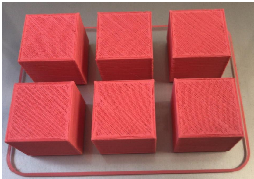
Figura 9.13. Tanda afectada por obstrucción de la boquilla. [F.P]
