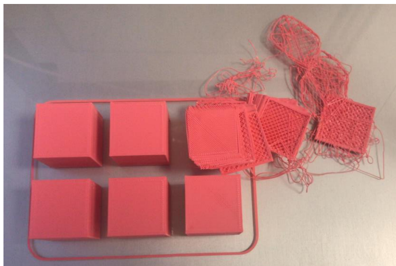
Figura 9.21. Probeta despegada de la cama. [F.P]
