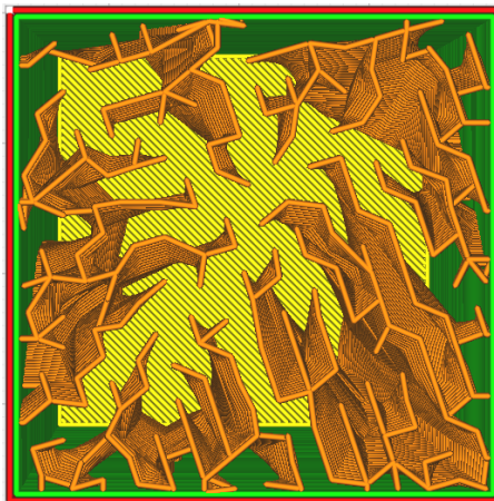
Figura 6.9. Patrón de relleno Lightning al 20%. [F.P]
