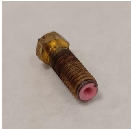
Figura 9.15. Boquilla parcialmente obstruida. [F.P]
