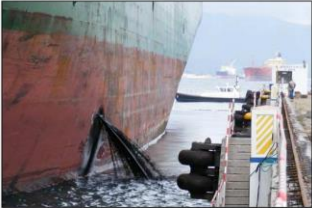
Ilustración 35: Brecha en el costado de babor.
