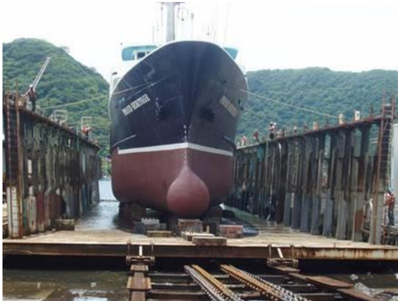
Ilustración 13: Buque elevado en rampa de varadero. Fuente:
